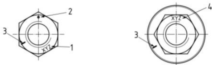
图 7 全承载能力六角螺母标记示例
